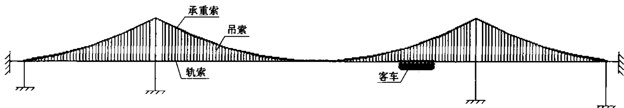
图 1 空中客车系统总体布置
