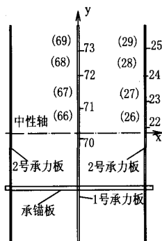
图 4 简化模型正面布点图
