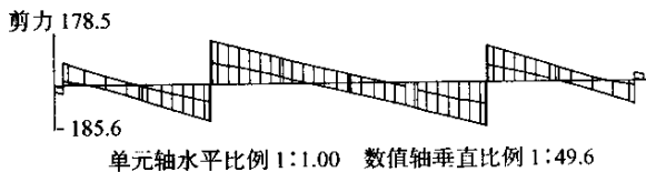
(2) 荷载组合作用下主梁剪力包络图
