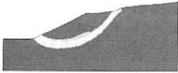
图 7 无膨胀力作用下的塑性区
