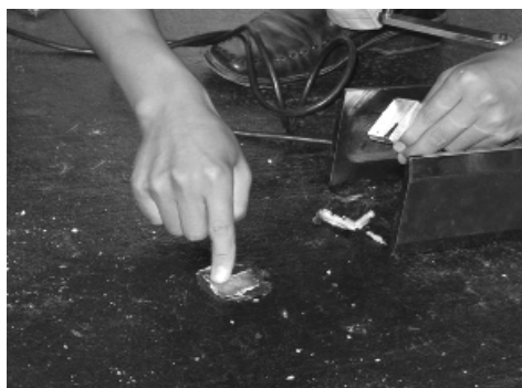
图 5 桥面防水层粘结强度检测试验
