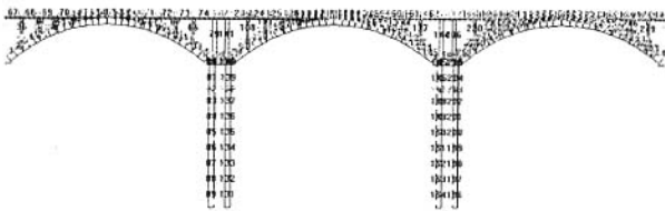
图 6 土山桥平面有限元结构模型
