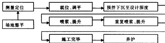
图2 深层水泥搅拌桩施工工艺流程图
