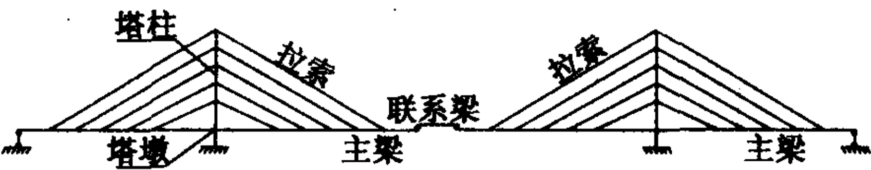
图 1 三塔四跨对称布置示意图 m
