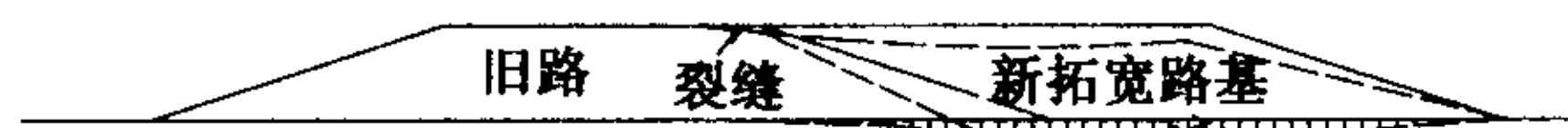
图 1 拓宽路堤引起原有路堤的变形
