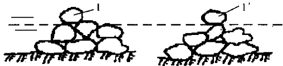
图 2 剪切膨胀示意图
