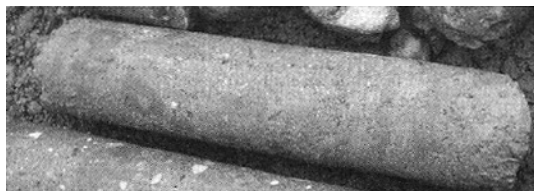
(2) 桩身在 24.00~24.5 m 处只有混凝土砂浆胶结物,无卵石骨料
