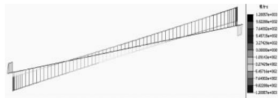
图 10 承载力极限组合下剪力包络图(单梁模型)
