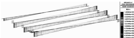
图7 承载能力极限组合下剪力包络图(梁格模型)
