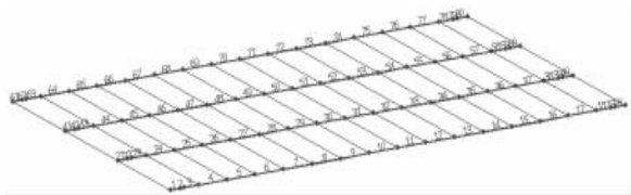
图4 小箱梁单元划离散图
