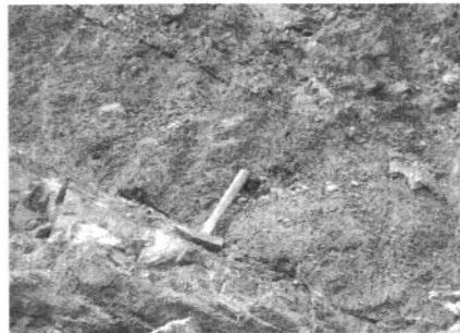
图 3 滑动带中的粘土层
