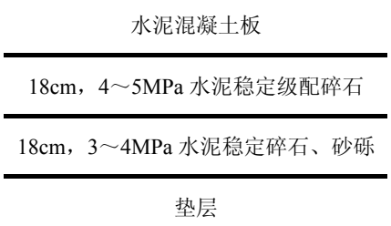
图 6-1 广东省水泥混凝土路面常用基层结构
