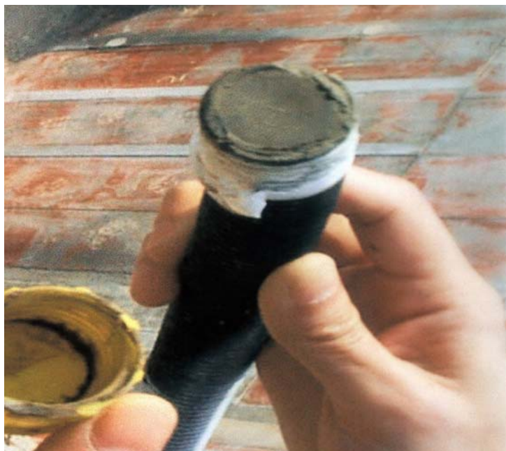
图 4 说明：通过观察孔，检测压浆质量
