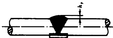
图 2 焊缝余高
