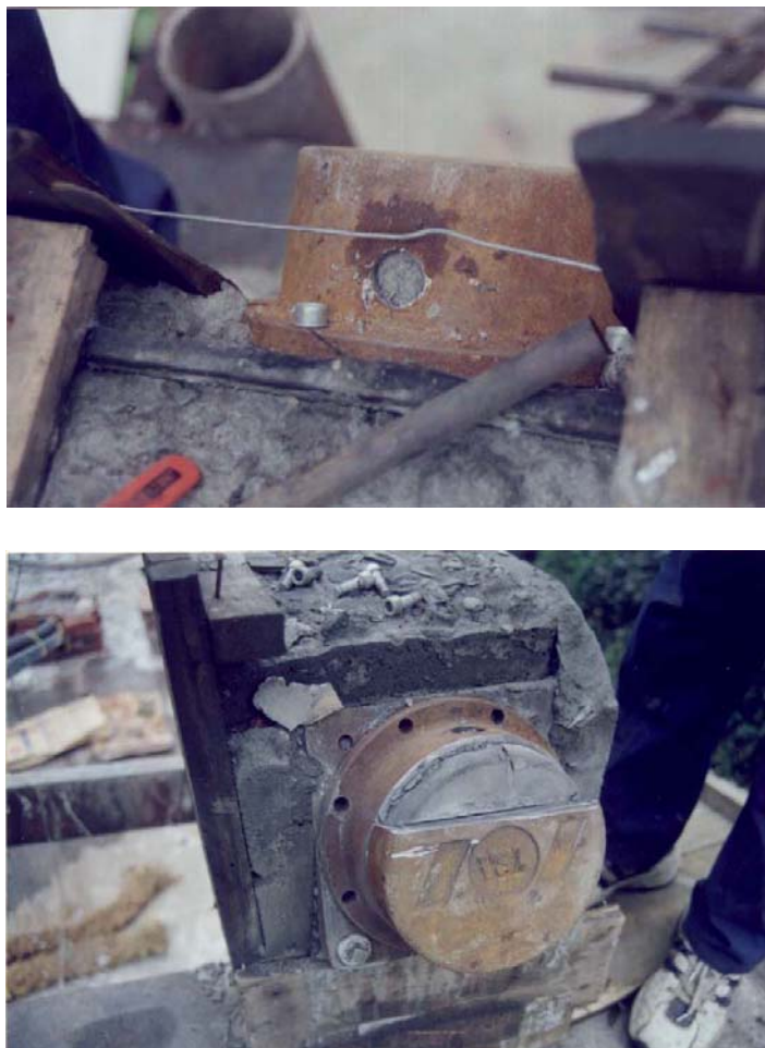
图 3：通过观察孔，检测压浆质量
