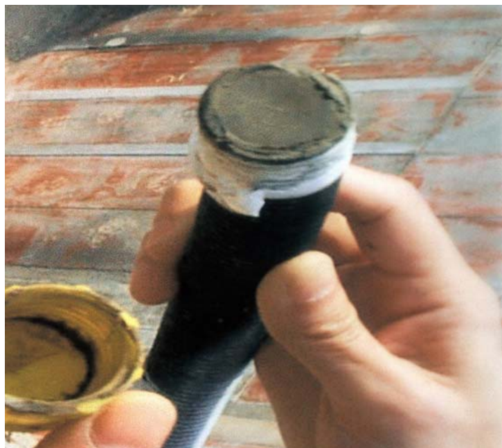
图 4 说明：通过观察孔，检测压浆质量
