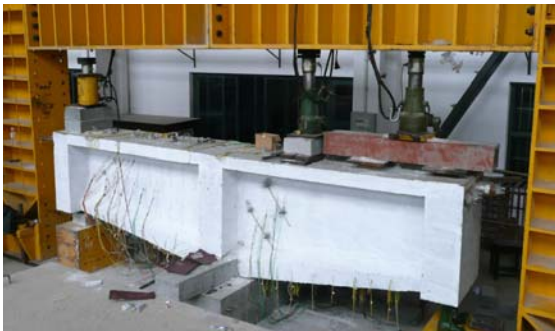
预应力腹板极限状态试验
